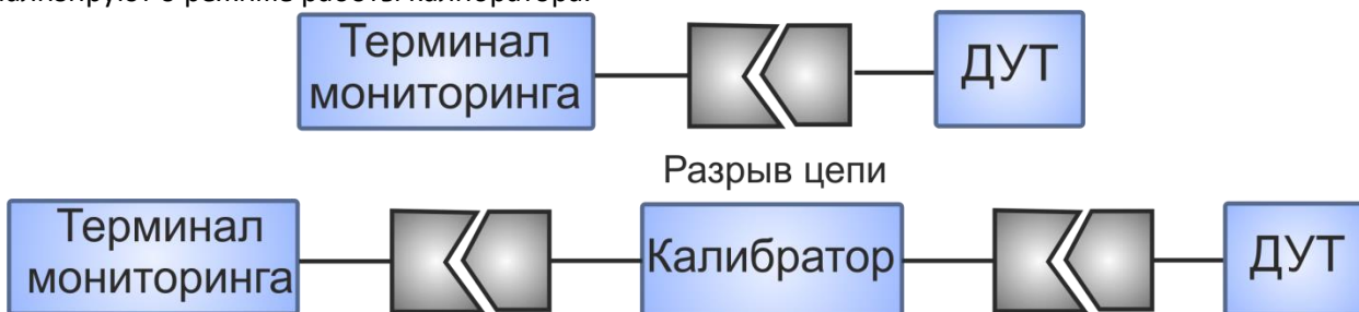
Рисунок 26 – Подключение калибратора в разрыв цепи «Терминал – ETS.A»
