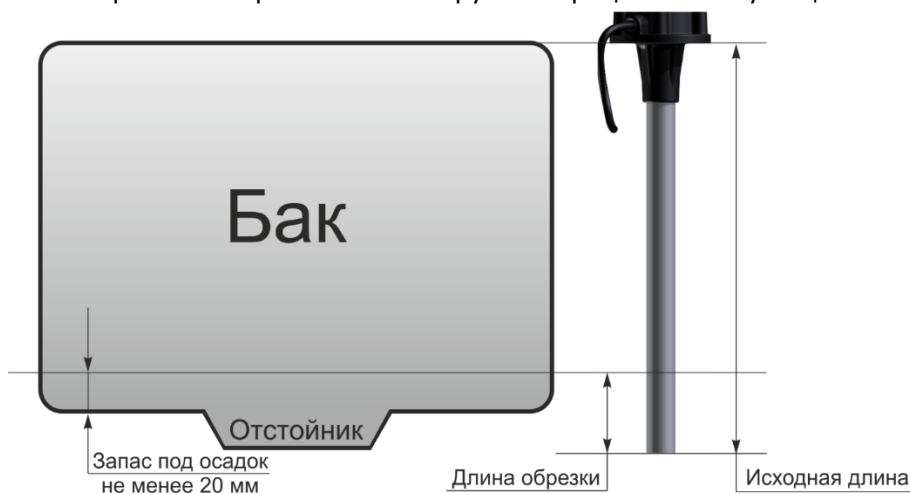
Рисунок 15 – Схема обрезки датчика
